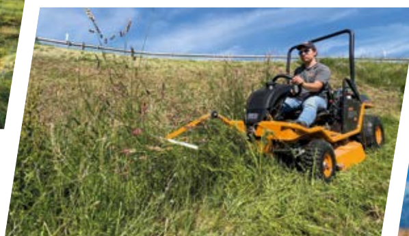
Insektenschonendes Mähen mit Scheuchvorrichtung
