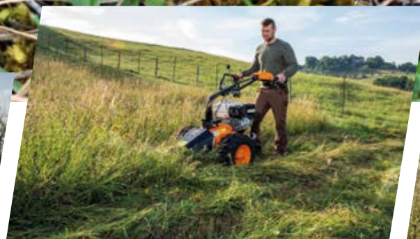
Schonender Schnitt mit Doppelmesser-Mähbalken
